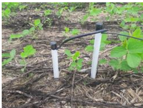
Figure 1: 1 paire de sondes tensiométriques à 30 et 60 cm
